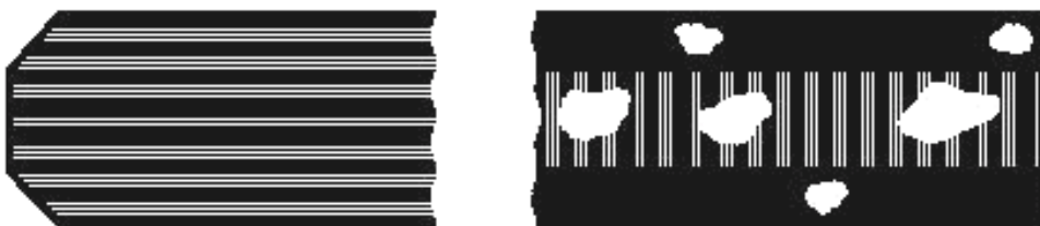
Рисунок А.2 — Грубошлифованная кромка
