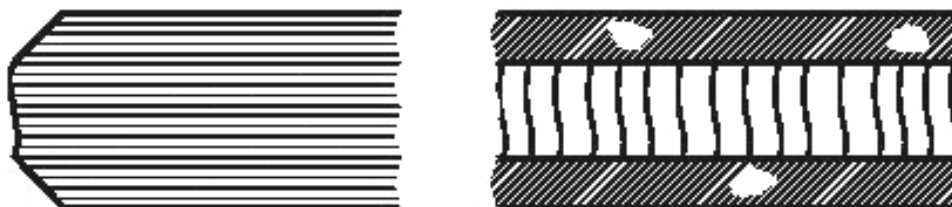
Рисунок А.1 — Притупленная кромка
